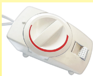
1995: Coperta riscaldante americana a misuratore di potenza, simile a quella sviluppata più di 50 anni prima da Cook nel 1942. Vista esterna e vista del bimetallo interno ha un interruttore lento con resistenza anticipata. L'unico sviluppo degno di nota di questo modello è l'inclusione di un filtro antidisturbo (Ultimheat Collection)
