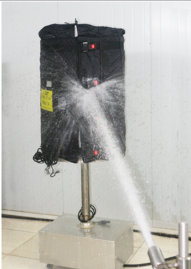
Test IPx6 dei riscaldatori a mantello
