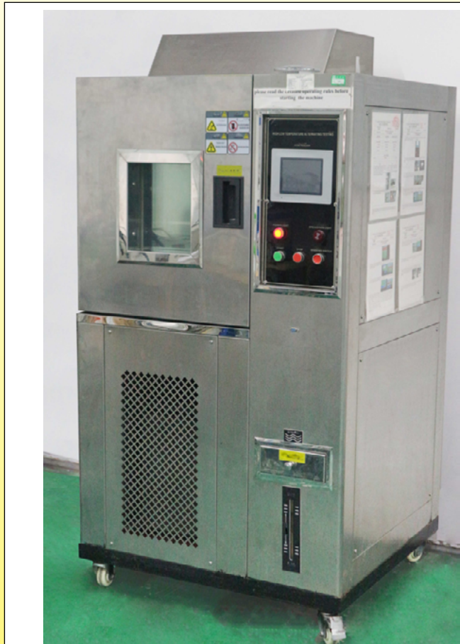
Camera climatica, con intervallo di regolazione della temperatura da -90 a +150^{\circ}C , intervallo di regolazione dell'umidità relativa da 1 a 100%.
