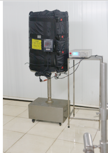
Misurazione della resistenza di isolamento dopo i test IPx6
