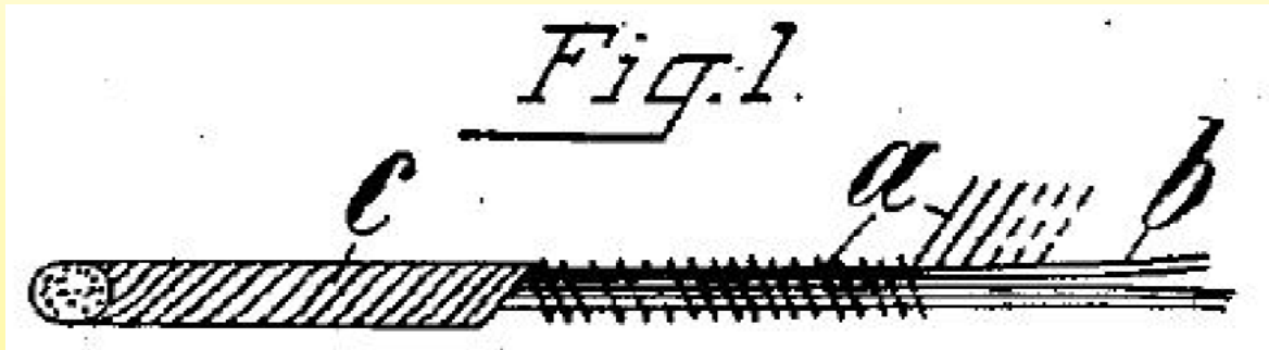
Cavo scaldante (brevettato da Camille Herrgott, 1901). A = filo scaldante; B = anima tessile; C = involucri esterno avvolto in direzione opposta al filo scaldante.
